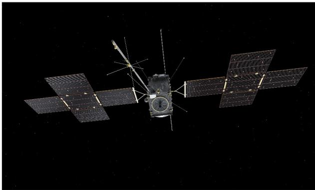
**5. Solarzellen wurden für die Stromversorgung ausgeklappt. Sie sind ungefähr so groß wie eine durchschnittliche Wohnung in Deutschland: 60-75 m<sup>2</sup>. Sie müssen so groß sein, da das Sonnenlicht 25 Mal schwächer ist als auf der Erde.**
